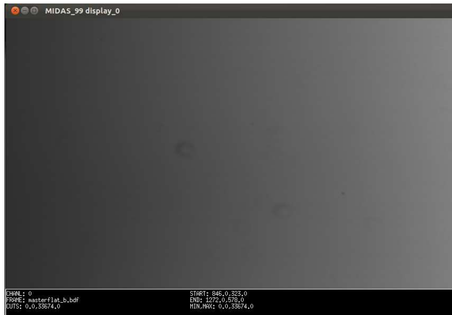
Abbildung 4.3: Eine Beispielaufnahme eines Flatfields. Zu sehen ist ein kontinuierlicher Verlauf der Pixelwerte, die nach rechts zunehmen.
