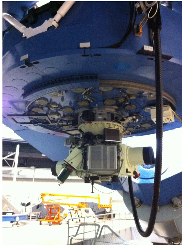
Abbildung 3.6: Das Photo zeigt den TWIN-Spektrographen aus der Nähe. Die einzelnen Bestandteile sind in Abbildung 3.7 beschriftet.
