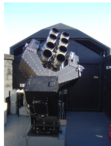
Abbildung 1.6: 8 Weitfeldkameras von SuperWASP
