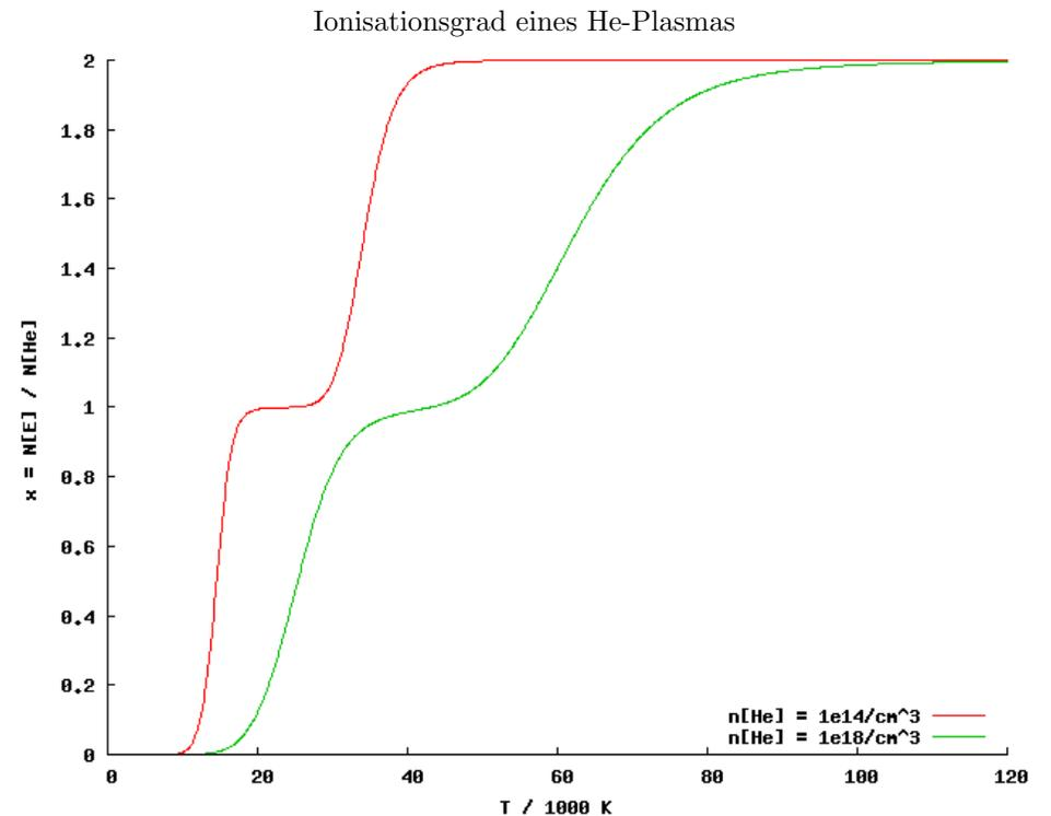
Man sieht deutlich, daß sich das dünnere Heliumgas schon bei geringeren Temperaturen ionisieren läßt als das dichtere und daß Schwellen beim Ionisationsgrad  $x = 1$  auftreten. Die Schwelle ist beim dünneren Plasma deutlicher ausgeprägt.
