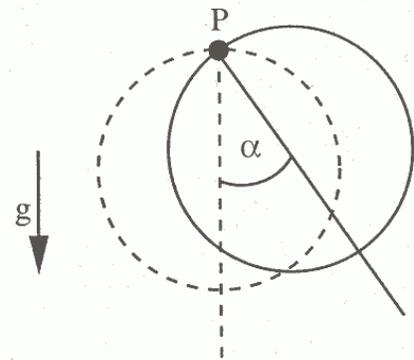
1. Berechnen Sie das für die Schwingung relevante Trägheitsmoment der Scheibe bezüglich der senkrecht durch den Aufhängepunkt  $P$  verlaufenden Rotationsachse.
