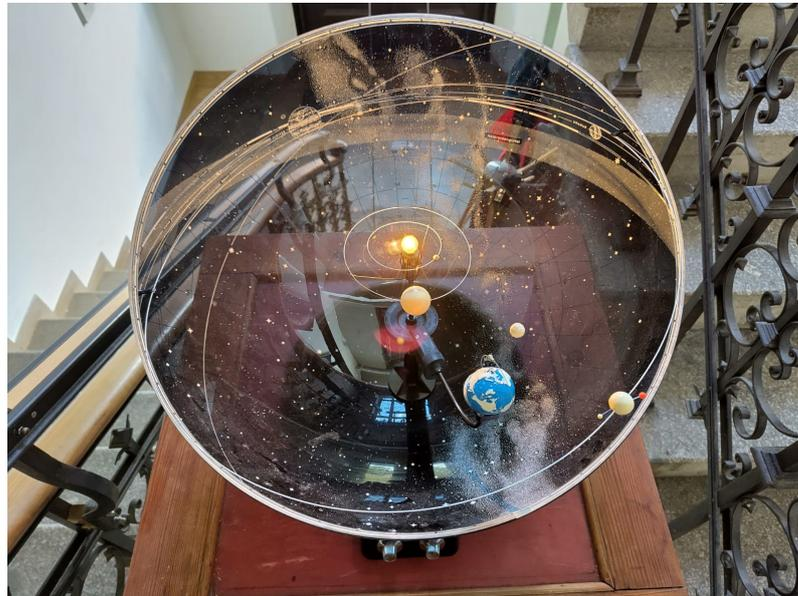
**Abbildung 11:** Das elektrisch betriebene Tellurium in der Haupthalle der Sternwarte veranschaulicht die Bewegung von Erde und Mond im inneren Sonnensystem. Als didaktisches Modell unterstützt es die Einführung in grundlegende astronomische Konzepte.
