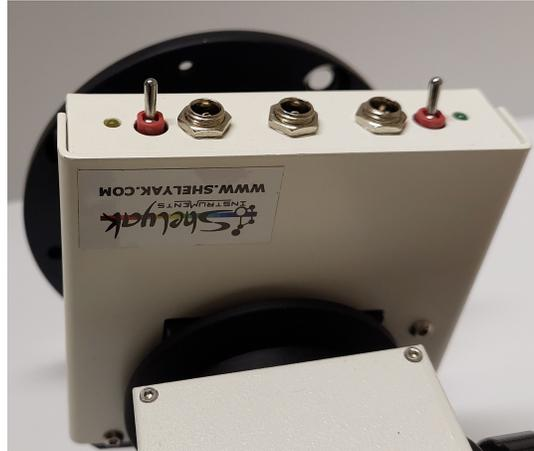
Abbildung 16: Shelyak Remote Calibration Fake Filterrad mit dem Anschluss der Flatlampe links und der Kalibrationslampe rechts sowie der Stromzufuhr in der Mitte (eigene Aufnahme)
