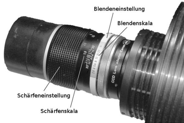
Abbildung 5.6: CCD-Kamera mit Objektiv und dessen Einstellringe für Schärfe und Blende.
